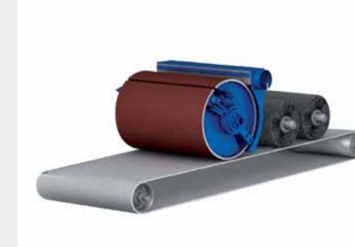
Schlackeentfernung, Entgratung und Kantenbrechen von Blechen im Trockenverfahren
