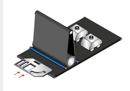
Entgratung, allseitig gleichmäßige Kantenverrundung und Oberflächenschleifen von Blechen im Trockenverfahren
